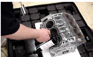
Recubrimiento VCI de Zerust por medio de rocío
