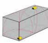
Em grandes compartimentos, duas cápsulas podem ser colocadas em cantos opostos na diagonal para proteger completamente todo o espaço.
