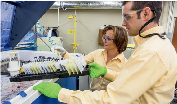
Cámaras de humedad se utilizan para pruebas, como evaluar los fluidos de proceso de un cliente y la efectividad de las soluciones contra la corrosión recomendadas
