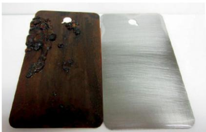
A la izquierda: sumergido en agua sin tratar (60 ppm Cl<sup>-</sup>, 300 ppm CaCO<sub>3</sub>), a la derecha: sumergido en agua tratada con AxxaVis™ HST-10.
