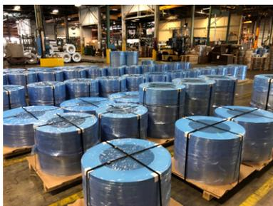
Las fundas de bobina VCI ZERUST® se pueden hacer para adaptarse a varios tamaños de bobinas metálicas.
