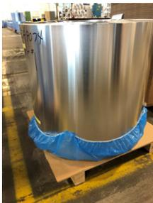
La funda de bobina VCI ZERUST® se sube sobre la parte inferior de la bobina.
