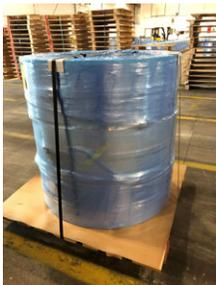
El embalaje terminado incluye una funda de bobina VCI ZERUST® en la parte inferior y superior de la bobina. Luego, el operador utiliza película estirable VCI ZERUST® para envolver y cerrar completamente el embalaje antes de usar bandas para asegurar la bobina a la plataforma.
